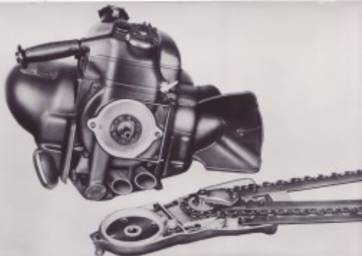
Der komplette Sägekopf ist nach Lösen von nur zwei verschraubten Schrauben abzunehmen. Auch die Montage dauert natürlich nur ein paar Sekunden, so daß die Säge nach einem Transport immer gleich wieder benutzbar ist.
