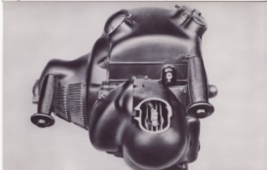
Trotz der Kapselung ist alles greifbar, weil man zu die Teile des Motors, die einer gewissen Pflege bedürfen, langsam lösen kann. So braucht man beispielsweise nur eine Kloppe in der Zündensicherung zu öffnen — ohne Werkzeug natürlich — und schon liegt die Luftpumpe zur Verfügung.
